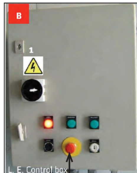
Bouton d'arrêt d'urgence sur la boîte de contrôle de la nacelle
